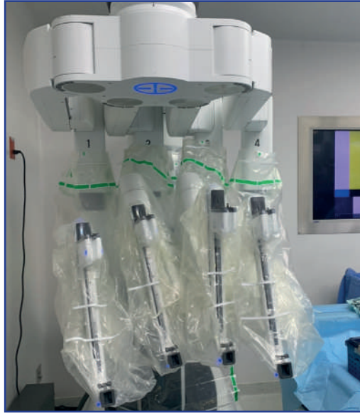
Figura 4. El carro robótico tiene tres brazos de trabajo y un cuarto más para el endoscopio. Es supervisado por el personal en el quirófano.
