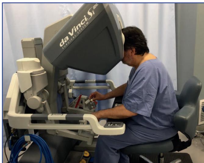
Figura 2. Consola de mando del cirujano. Es el centro de control del sistema desde el cual el cirujano opera. El visor proporciona dos imágenes del campo quirúrgico que, juntas, ofrecen una visión tridimensional. Fuente: Imagen tomada del archivo fotográfico de la Subdirección de Cirugía del Instituto Nacional de Enfermedades Respiratorias Ismael Cosío Villegas.
